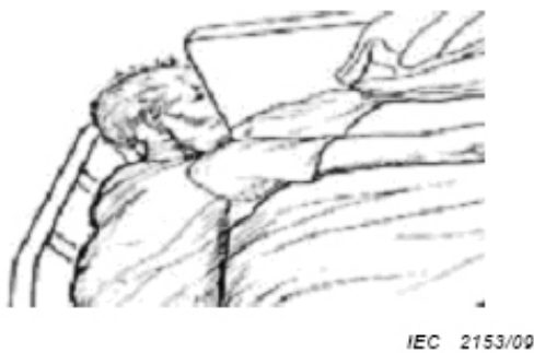
Gambar AA.15 – Contoh jeratan pasien yang potensial terjadi dalam area C diantara jeruji samping dan papan pada sisi kepala
