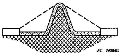
Gambar 25 - Jarak rambat dan celah udara – Contoh 4
