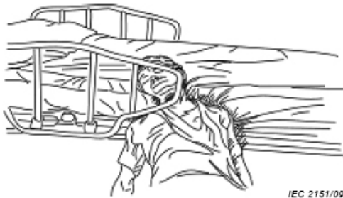
Gambar AA.13 – Contoh jeratan pasien yang potensial terjadi pada area B
